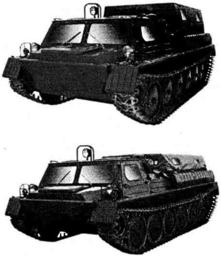
**Новый снегоболотоход требует особенно тщательного наблюдения и ухода на протяжении периода обкатки, установленного в 300 км пробега.**
